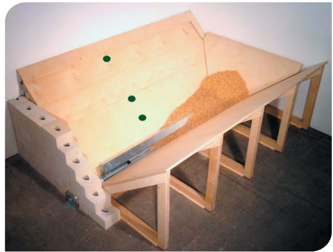
[Abb. 19] Drucksensoren zur Füllstandsmessung im Schrägbodenlager
